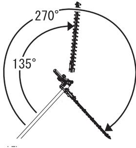
Les lames peuvent être réglées dans dix positions différentes, allant d'un angle de 135° à 270° par rapport au tube extérieur, comme indiqué. Toujours s'assurer que le levier de verrouillage est correctement bloqué après chaque réglage.
