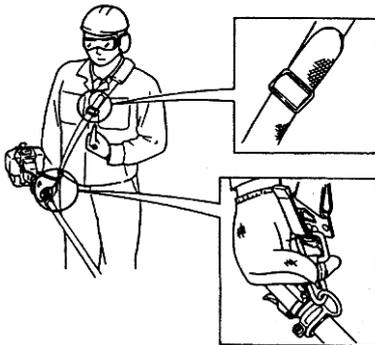
1. Accrocher le crochet de la sangle sur la fixation du tube extérieur.
