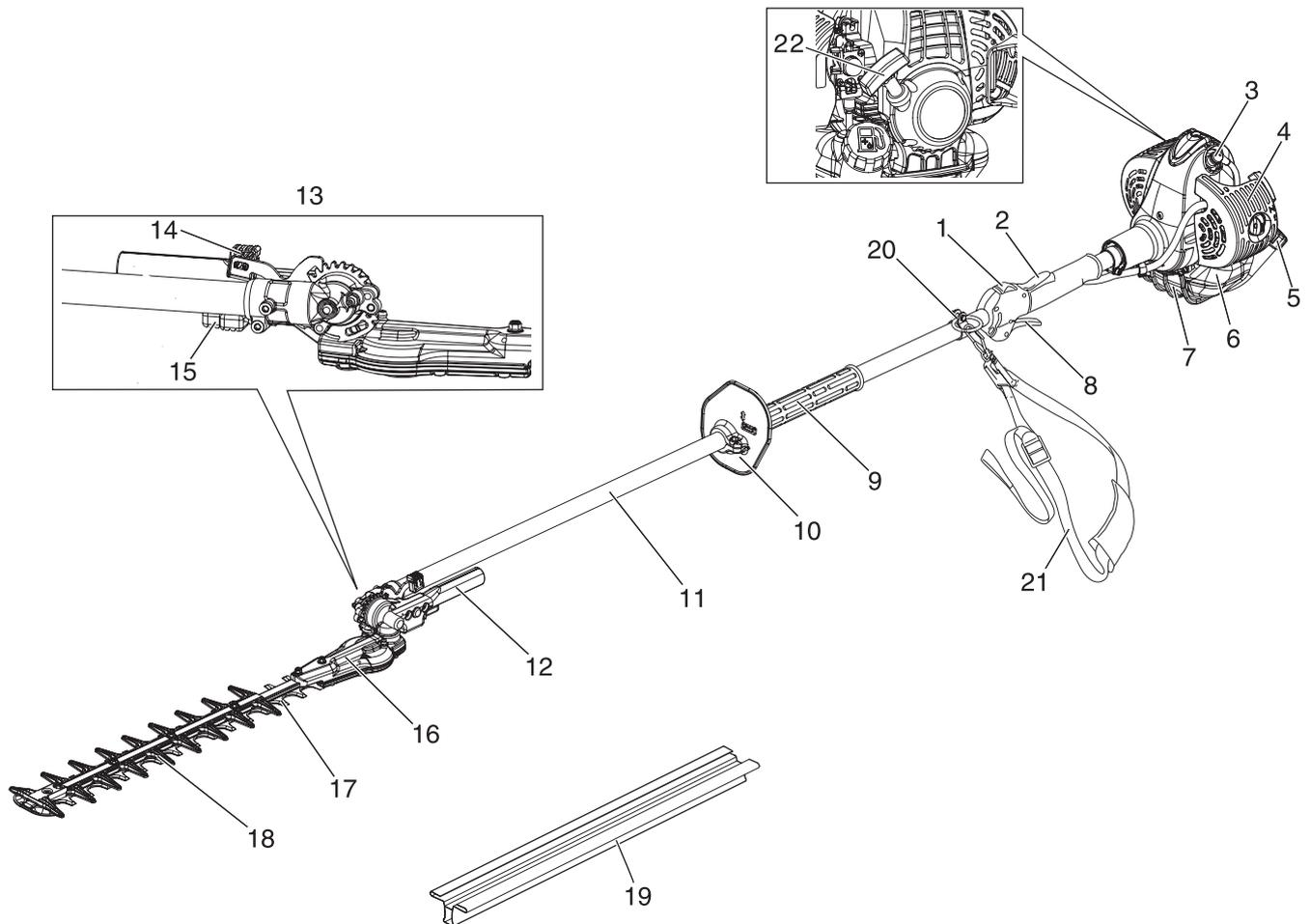
1. **Interrupteur marche/arrêt** Dispositif permettant la mise en marche et l'arrêt du moteur.
