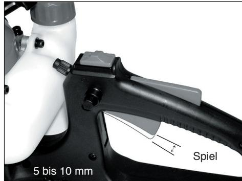
2. Wenn eine Einstellung des Spiels nötig ist, lockern Sie die beiden 10-mm-Gaszugmuttern an der Gaszughalterung.
