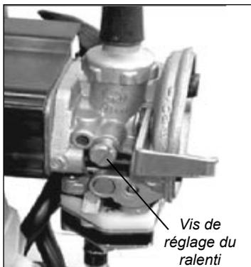
(1) Poser l'appareil sur le sol, puis démarrer le moteur et le laisser tourner au ralenti pendant 2 à 3 minutes jusqu'à ce qu'il soit chaud.
