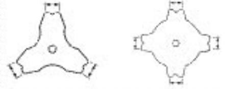
L'angle d'affûtage doit être d'environ 45°. ne pas trop affûter les extrémités de la lame. Laisser 0,2 à 0,5 mm d'espace non affûté.
