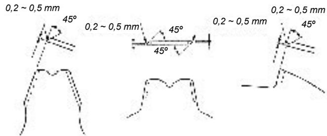
La partie inférieure de chaque dent ne doit pas être affûtée. (Vue de la lame par le dessous)
