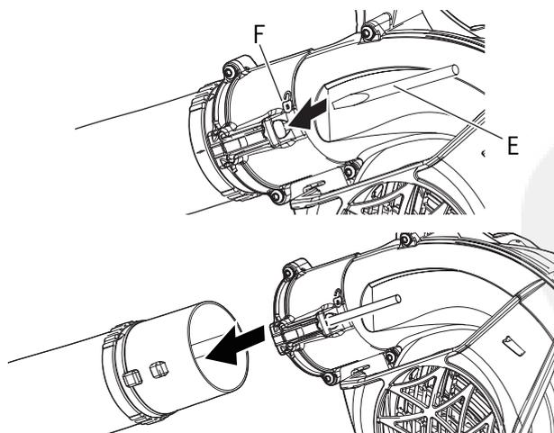
1. Insérer le tournevis (E) dans l'orifice situé près du symbole de blocage (F) pour débloquer le tuyau.
