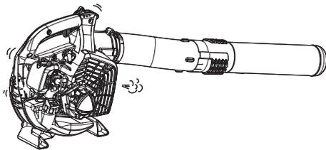
1. Lorsque le moteur démarre, le laisser chauffer au ralenti (c.-à-d. à bas régime) pendant 2 à 3 minutes.
