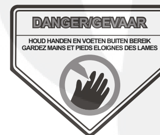
Figuur 2: veiligheidslabel op grasmaaier: BLIJF MET HANDEN EN VOETEN UIT DE BUURT VAN DE MACHINE
