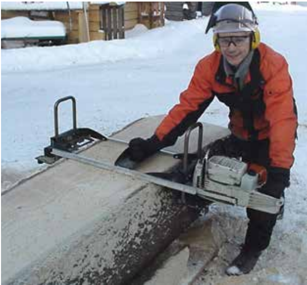
LSG sans rails guides. La surface plate de la grume oriente la prochaine coupe.
