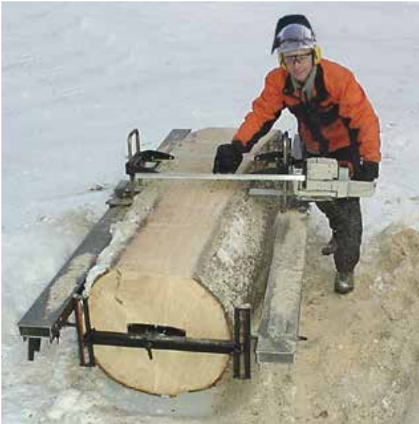
Machine à Bois PRO: LSG avec rails guides doubles, Bras EXT et Plaque de Fixation EXT. Les profils coulissants (n° 4 page 27) ne touchent pas le grume.
