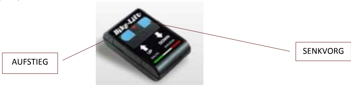
Abbildung 7 – elektronische Druckknopftafel mit Fernsteuerung und Totmanntastenschaltung
