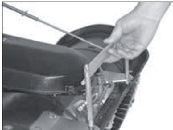
2) Verriegelung in hinterer Position.
