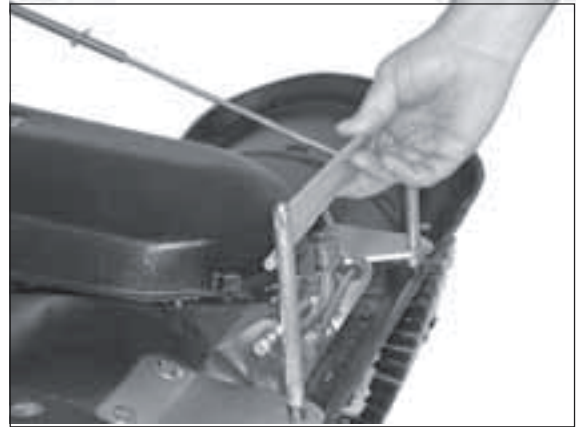
2) Verriegelung nach hinten geklappt.
