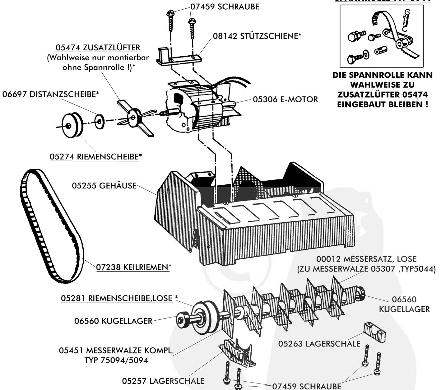
DIE MIT EINEM " \* " GEKENNZEICHNETEN TEILE SIND IM UMBAUSATZ 08323 ENTHALTEN.
