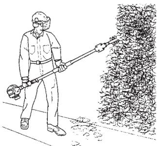
Actionner la gâchette d'accélérateur après le démarrage du moteur entraîne l'augmentation du régime moteur et le mouvement des lames. Régler le régime moteur en fonction de la quantité de haies à couper, par exemple.
