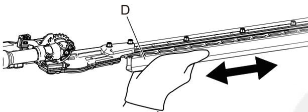
1. Positionner le taille-haie sur une surface plane avec le moteur posé sur la protection du réservoir de carburant. S'assurer que l'étui protecteur de lame est en place sur la lame.
