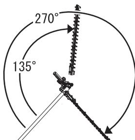
Les lames peuvent être réglées dans dix positions différentes, allant d'un angle de 135° à 270° par rapport au tube extérieur, comme indiqué. Toujours s'assurer que le levier de verrouillage est correctement bloqué après chaque réglage.
