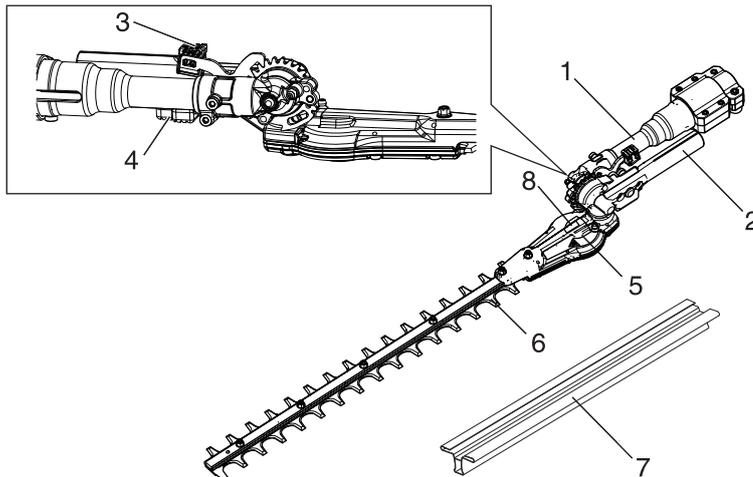
1. **Tube extérieur** Pièce de l'appareil qui protège l'arbre de transmission.
