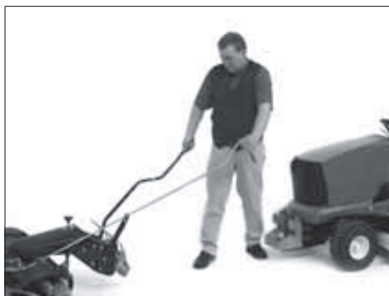
2) Kehrmaschine an den Rasentraktor heranziehen.
