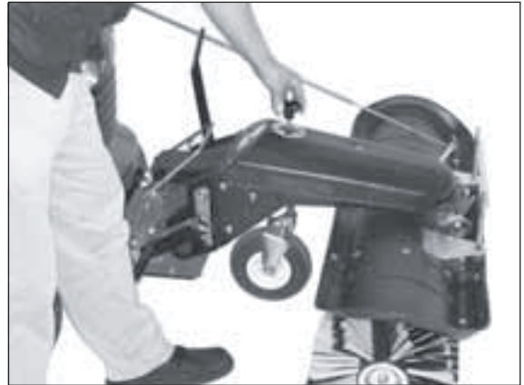
2) Das Stützrad läßt sich durch das Drehen am Ballengriff in der Höhe verstellen.
