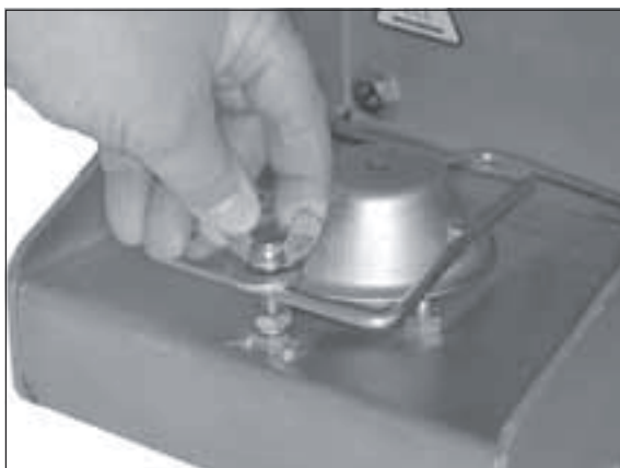
1) Flügelschraube am Schutz der Schnellkupplung lösen.
