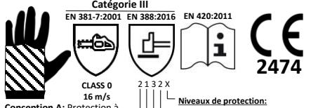
Conception A: Protection à l'arrière du gant gauche seulement, pas de protection dans les doigts ou le pouce.
