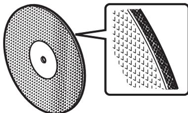
1. Les meules sont réalisées en déposant une structure à maillage de fibres solides dans une forme, puis en y déversant un mélange de résine et de particules à grains abrasifs et en surmontant ce mélange d'une seconde couche de maillage. Ensuite, la résine et le maillage renforcé sont liés puis durcis ensemble.
