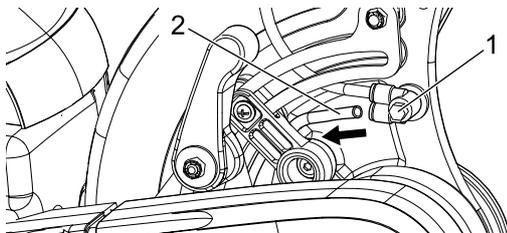
1. Raccord de tuyau      2. Tuyau de rinçage d'eau
