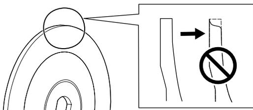
1. La vérifier à la recherche de signes d'usure, de fissures et de pièces cassées.
