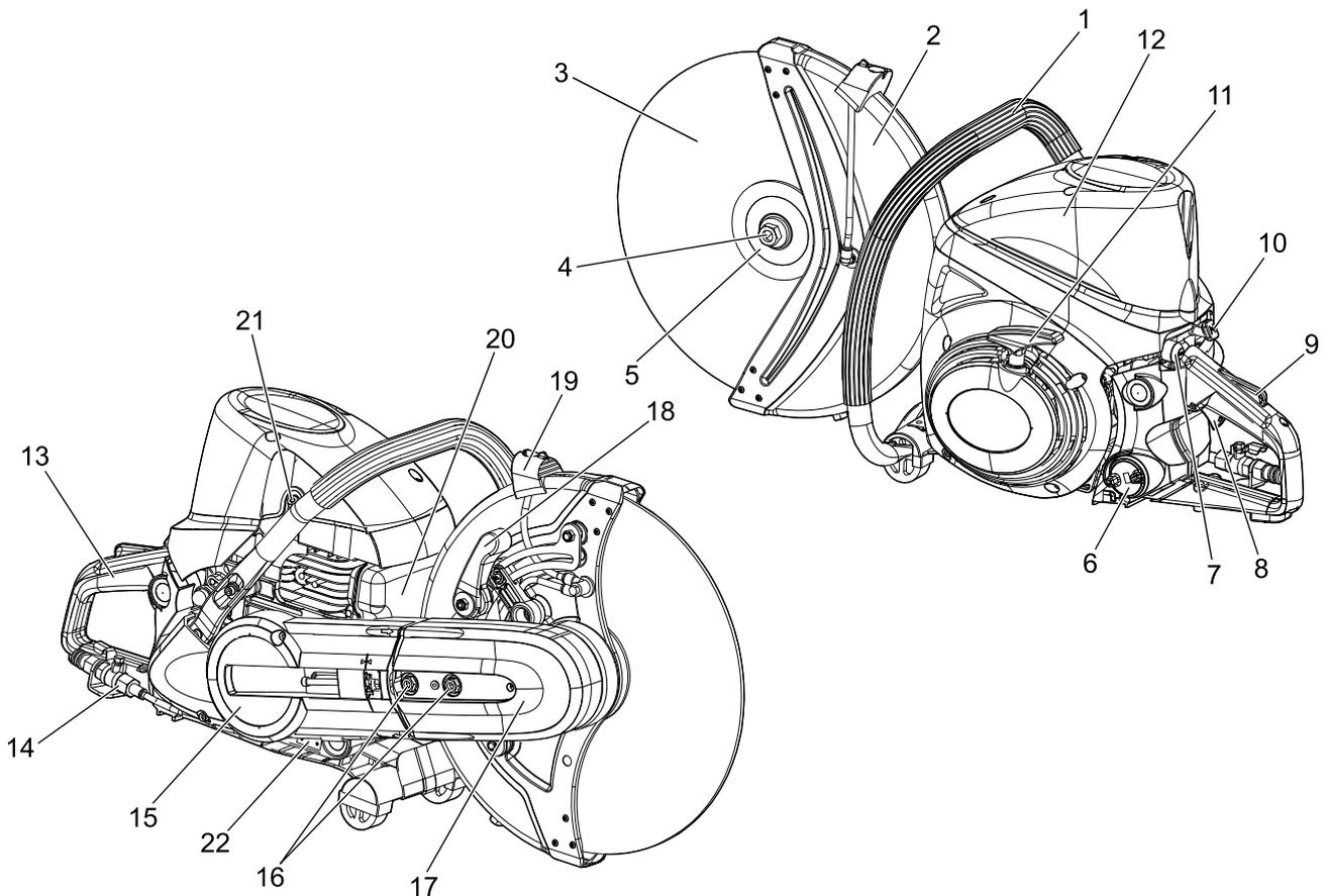
1. **Poignée avant (pour la main gauche)** - Poignée de support située à l'avant du bloc du moteur.
