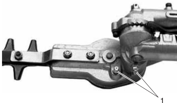
1. Embouts de graissage du carter d'engrenage
