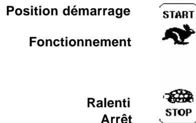
Position démarrage, le starter est engagé. Il doit être désengagé dès que le moteur est lancé afin d'éviter l'engorgement du carburateur.
